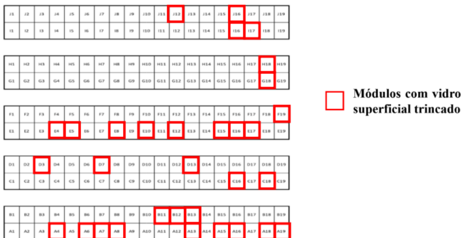
Figura 7 – Identificação dos módulos com vidro rachado.
