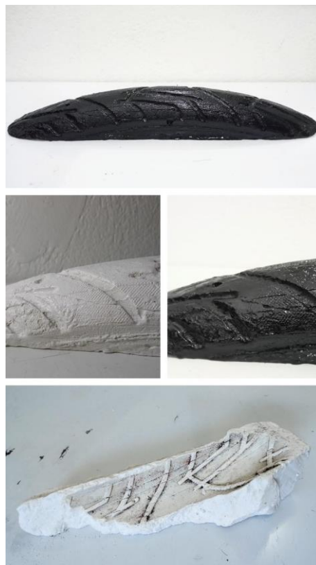
Processo de molde de pneu de bicicleta em gesso. Fonte: Herbert Farias, 2023
