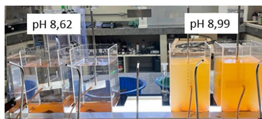
Figura 4 - Água sintética tratada com 50mg/L de PAC
