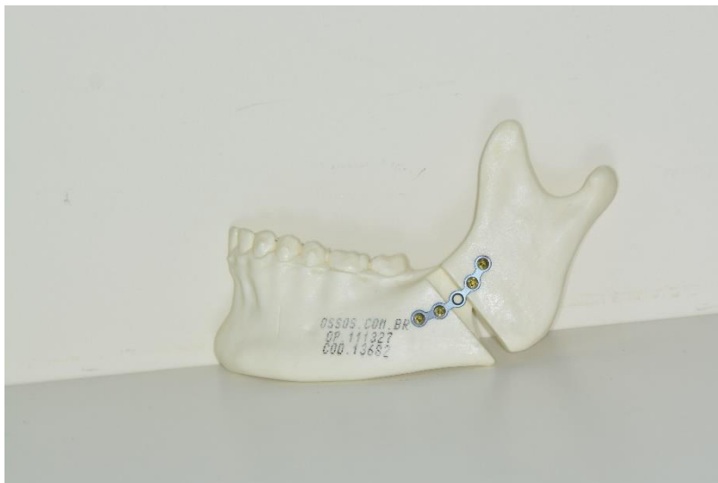
Figura 6 - Demonstração da fixação com Placa curva 5 furos 0,8mm de espessura sistema 2.0 (Grupo 3).
