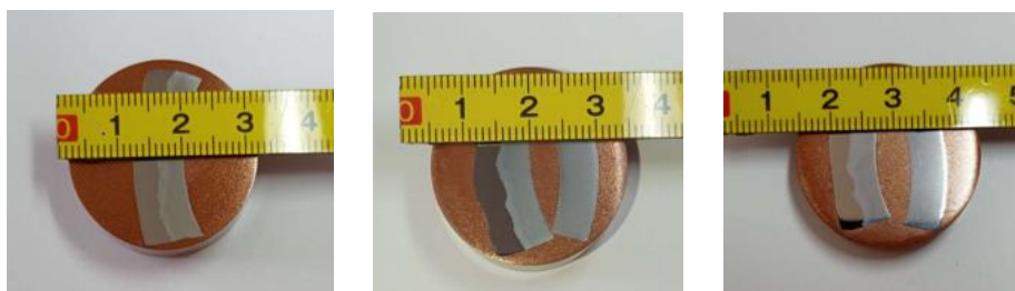
Figura 6- Macrografia amostras 1B, 2A, 3C (superior) e 7D, 8A, 9A (inferior); Ataque Nital 3%. Corte transversal.
