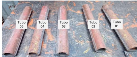
Figura 2 – Identificação dos tubos novos, vista da geratriz não revestida.
