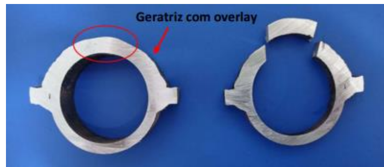
Figura 5- Detalhe da região removida para embutimento.
