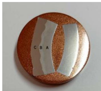
Figura 6- Macrografia contendo a região do metal base (A), zona de fusão (B) e overlay (C).
